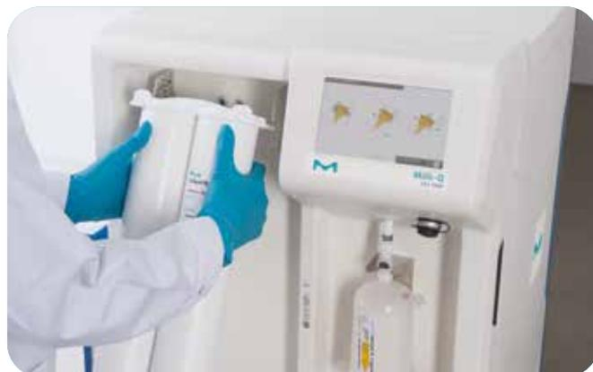
メルクのエルゴノミクスに配慮した特許取得済みのバックロッキングシステムで、すばやく簡単にカートリッジ交換できます。
