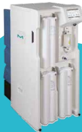
Milli-Q® CLX 7000システムは自動給水により分析装置に1日あたり最大1500 LのCLRWを給水できます。
