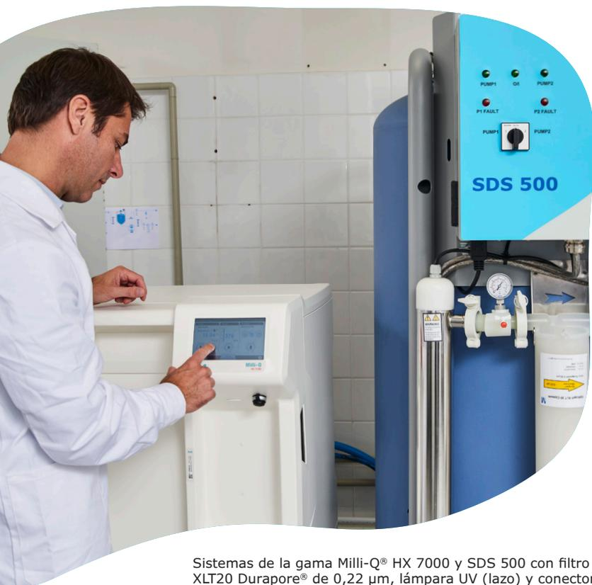
Sistemas de la gama Milli-Q® HX 7000 y SDS 500 con filtro de lazo Opticap® XLT20 Durapore® de 0,22 µm, lámpara UV (lazo) y conectores TC.
