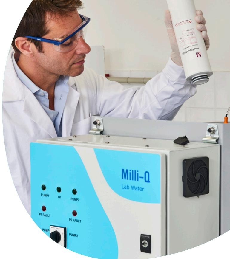
Técnico de laboratorio cambiando los filtros de venteo SDS 500
