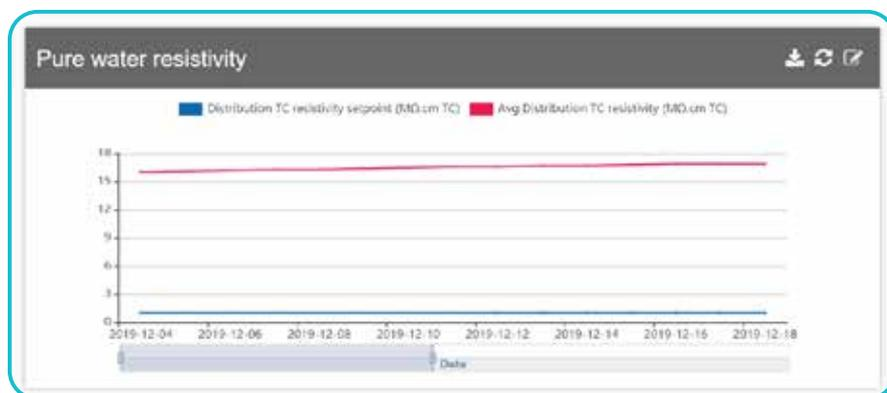
Se representan gráficamente los parámetros de calidad del agua (resistividad, temperatura, TOC) a lo largo de la línea temporal que usted elija y pueden descargarse fácilmente.
