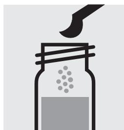
Añadir 1 microcuchara azul rasa de  $\text{NO}_3\text{-1K}$  en un tubo de ensayo. Cerrar **inmediatamente** la cubeta firmemente. **¡Atención, intensa formación de espuma (gafas de protectoras, guantes)!**
