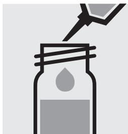
Pipetear 4,0 ml de la muestra en una cubeta de reacción, cerrar con la tapa roscada y mezclar.
