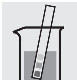
Comprobar el valor del pH de la muestra, intervalo necesario: pH 2–7. En caso necesario, corregir el valor del pH añadiendo gota a gota solución diluida de hidróxido sódico o de ácido sulfúrico.
