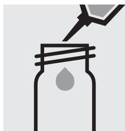
Pipetear 5,0 ml de la **muestra preparada** en una cubeta de reacción, cerrar con la tapa roscada y disolver la sustancia sólida.
