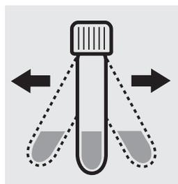
**Agitar intensamente** la cubeta durante **1 minuto** para disolver la sustancia sólida.
