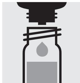
Introducir 6 gotas de **Sn-1K** en una cubeta de reacción, cerrar con la tapa roscada y mezclar.
