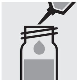
Pipetear 5,0 ml de la muestra en una cubeta de reacción, cerrar con la tapa rosca y mezclar.
