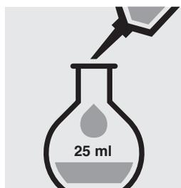
Pipetear 4,0 ml de la muestra en un matraz aforado de 25 ml.
