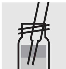
Con una pipeta Pasteur aspirar 0,5 ml de la fase inferior límpida.
