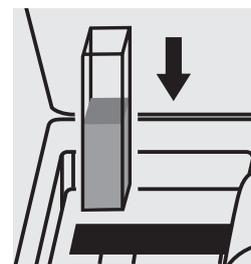
Introducir la cubeta en el compartimiento para cubetas. La medición del valor en blanco es efectuada automáticamente.
