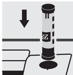
Seleccionar el método con el AutoSelector 1,0 – 15,0 mg/l de Ca.
