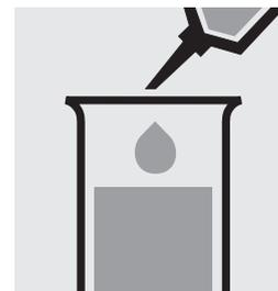
Añadir 5,0 ml de la muestra con la pipeta y mezclar.
