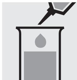
Pipetear 5,0 ml de  $\text{NH}_4\text{-1}$  en un tubo de ensayo.
