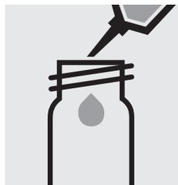
Pipetear 1,0 ml de **B-1K** en una cubeta de reacción, cerrar con la tapa roscada y mezclar.
