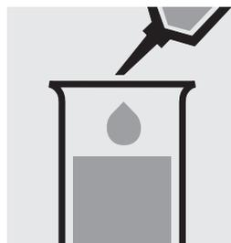
Añadir 0,20 ml de la muestra con la pipeta y mezclar.
