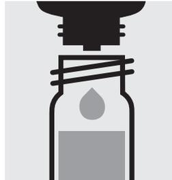
Añadir 4 gotas de pH-1, cerrar con la tapa rosca y mezclar. **Atención!** Para la dosificación mantener **verticalmente** el frasco de reactivo.
