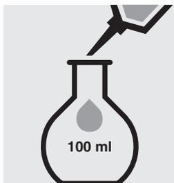
Introducir 50 ml de agua destilada (recomendamos el art. 1.16754, Agua para análisis EMSURE®) en un matraz aforado de 100 ml.
