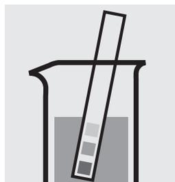
Comprobar el valor del pH de la muestra, intervalo necesario: pH 2–5. En caso necesario, corregir el valor del pH añadiendo gota a gota solución diluida de hidróxido sódico o de ácido sulfúrico.
