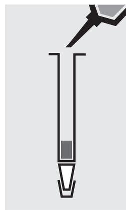
Cerrar la columna por la parte inferior. Añadir 1 ml de **AOX-3**. Cerrar la columna por arriba y agitarla por balanceo para eliminar las burbujas de aire. Abrir la columna por la parte de arriba y llenar hasta el borde con **AOX-3**.
