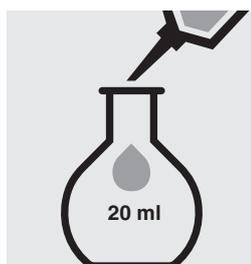
Introducir 10 ml de **reactivo de molibdato de sodio/ácido ascórbico** en un matraz aforado de 20 ml.
