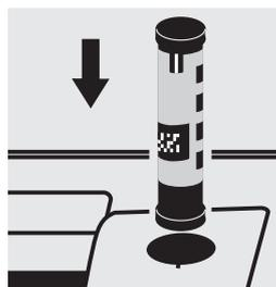
Seleccionar el método con el AutoSelector 10–250 mg/l de Cl.
