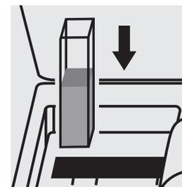
Colocar la **cubeta A** en el compartimento para cubetas. La medición es efectuada automáticamente.
