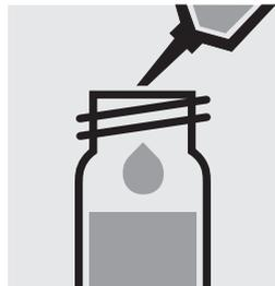
Añadir 5,0 ml de la **muestra desenriquecida** con la pipeta **cuidadosamente** en una cubeta de reacción, cerrar firmemente con tapa roscada y mezclar intensamente. **¡Atención, la cubeta se calienta!**
