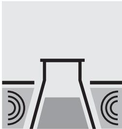
Si la muestra contiene burbujas de aire o gas: desgasificar en un baño ultrasónico.
