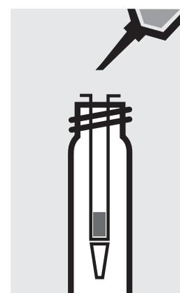
Separar la columna del despósito, hacer recorrer completamente 3 veces 1 ml cada vez de **AOX-3** a través de la columna. Dejar la solución de lavado.
