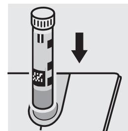
Colocar la **cubeta A** en el compartimiento para cubetas. Hacer coincidir la raya de marcado de la cubeta con la marca de fotómetro. La medición es efectuada automáticamente.
