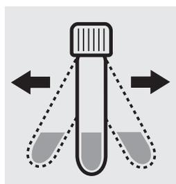
Agitar intensamente durante 30 segundos. Dejar en reposo para que se separen las fases.
