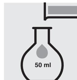
Transferir con **ácido sulfúrico 0,05 mol/l** a un matraz aforado de 50 ml.
