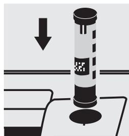
Seleccionar el método con el AutoSelector 5 – 160 mg/l de Ca.
