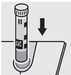
Colocar la cubeta en el compartimiento para cubetas. Hacer coincidir la raya de marcado de la cubeta con la marca de fotómetro. La medición es efectuada automáticamente. = cubeta B
