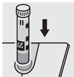
Colocar la **cubeta B** en el compartimiento para cubetas. Hacer coincidir la raya de marcado de la cubeta con la marca de fotómetro. La medición es efectuada automáticamente.
