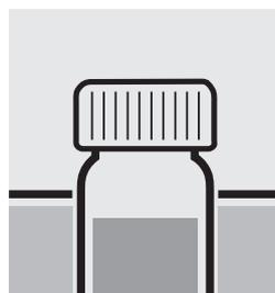
Regular la temperatura del tubo en el baño de agua a  $95 \pm 5$  °C durante **exactamente** 5 minutos.
