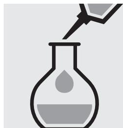
Añadir 20 ml de **reactivo de molibdato de sodio/ácido ascórbico** y mezclar.
