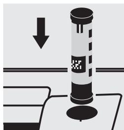
Seleccionar el método con el AutoSelector 1,0 – 20,0 mg/l de F.
