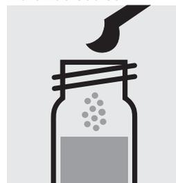
Añadir 1 microcuchara gris rasa de **Zn-5**, cerrar el tubo con la tapa roscada y disolver la sustancia sólida.
