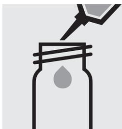
Pipetear 2,0 ml de la muestra en una cubeta de reacción, **no mezclar**.
