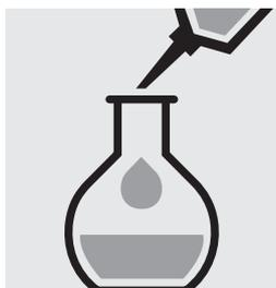
Completar el matraz aforado con **ácido sulfúrico 0,05 mol/l** hasta la señal de enrase y mezclar bien: **solución 1**.
