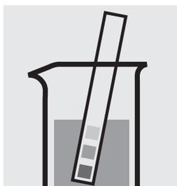
Comprobar el valor del pH de la muestra, intervalo necesario: pH 2–8. En caso necesario, corregir el valor del pH añadiendo gota a gota solución diluida de hidróxido sódico o de ácido nítrico.
