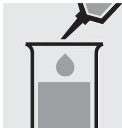
Pipetear 0,50 ml de SO<sub>4</sub><sup>-1</sup> en un tubo de ensayo.
