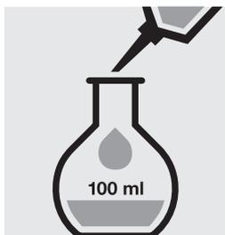
Pipetear 25 ml de la muestra en un matraz aforado de 100 ml, llenar con agua destilada hasta la señal de enrase y mezclar bien.
