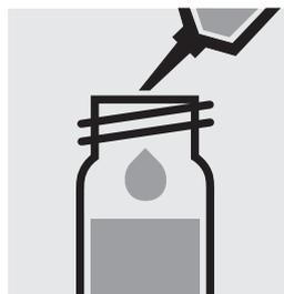
Pipetear 5,0 ml de la muestra en una cubeta de reacción, cerrar con la tapa roscada y mezclar.
