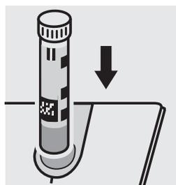
Colocar la cubeta en el compartimiento para cubetas. Hacer coincidir la raya de marcado de la cubeta con la marca de fotómetro. La medición es efectuada automáticamente. = cubeta A
