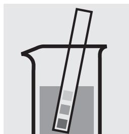
Comprobar el valor del pH de la muestra, intervalo necesario: pH 3–6. En caso necesario, corregir el valor del pH añadiendo gota a gota solución diluida de amoníaco o de ácido nítrico.
