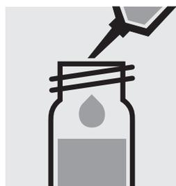
Añadir 0,50 ml de **NO<sub>3</sub>-2** con la pipeta, cerrar con la tapa roscada y mezclar. **¡Atención, la cubeta se calienta!**
