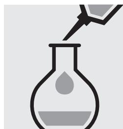
Añadir 1,0 ml de **reactivo 3** con la pipeta, llenar con agua destilada hasta la señal de enrase y mezclar bien.
