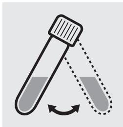
Poner en suspensión el sedimento del fondo de dos cubetas mediante agitación por balanceo.
