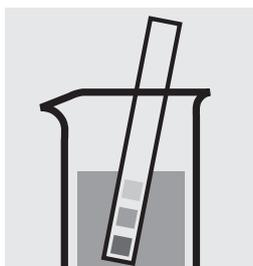
Comprobar el valor del pH de la muestra, intervalo necesario: pH 0–10. En caso necesario, corregir el valor del pH añadiendo gota a gota solución diluida de ácido sulfúrico.
