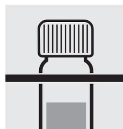
Sacar la cubeta del termorreactor, dejarla enfriar a temperatura ambiente en un soporte para tubos de ensayo: **muestra preparada**.
