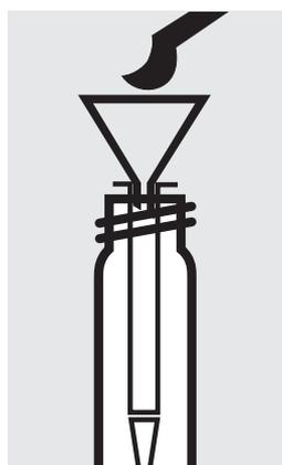
Colocar la columna en una cubeta redonda vacía, colocar encima el embudo d vidrio, introducir 1 microcuchara azul de **AOX-1**.
