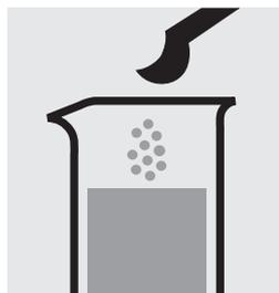
Añadir 1 microcuchara gris rasa de **Zn-1K** y disolver la sustancia sólida: **mezcla muestra - reactivo**.
