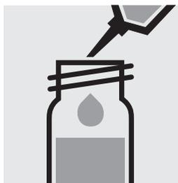
Añadir 0,10 ml de la muestra con la pipeta **cuidadosamente** en una cubeta de reacción, cerrar firmemente con tapa roscada y mezclar intensamente. **¡Atención, la cubeta se calienta!**
