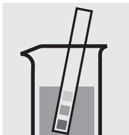
Comprobar el valor del pH de la muestra, intervalo necesario: pH 1–12. En caso necesario, corregir el valor del pH añadiendo gota a gota solución diluida de amoníaco o de ácido nítrico.
