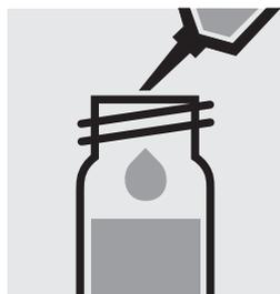
Añadir 0,5 ml de **Co-1K** con la pipeta, cerrar con la tapa roscada y mezclar.
