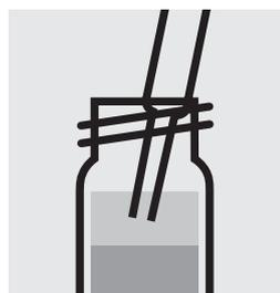
Mediante una pipeta Pasteur, aspirar la capa clara superior.
