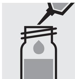
Pipetear 1,0 ml de la muestra en una cubeta de reacción, **no mezclar**.
