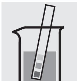
Comprobar el valor del pH de la muestra, intervalo necesario: pH 4–10.
