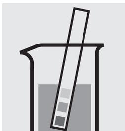
Comprobar el valor del pH de la muestra, intervalo necesario: pH 2–10. En caso necesario, corregir el valor del pH añadiendo gota a gota ácido sulfúrico diluido.
