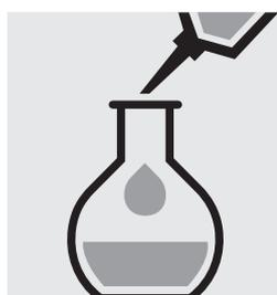
Añadir 25 ml de **reactivo de molibdato de sodio/ácido ascórbico** y mezclar.
