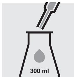
Introducir mediante pipeta de vidrio 20 ml de agua destilada (recomendamos el art. 1.15333, Agua para cromatografía LiChrosolv®) en un segundo matraz Erlenmeyer de 300 ml con NS 29/32.
