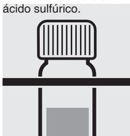
Sacar la cubeta del termoreactor, dejarla enfriar a temperatura ambiente en un soporte para tubos de ensayo.
