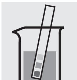
Comprobar el valor del pH de la muestra, intervalo necesario: pH <3. En caso necesario, corregir el valor del pH añadiendo gota a gota solución diluida de ácido sulfúrico.
