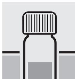
Incubar el tubo en un baño de agua según la EN 1141 [1] ó bien el Art. 64 del LFGB 31.00-7 [2].
