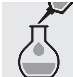
Completar el matraz aforado con agua destilada (recomendamos el art. 1.16754, Agua para análisis EMSURE®) hasta la señal de enrase y mezclar bien.
