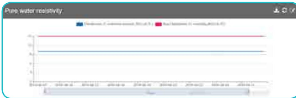
Se representan gráficamente los parámetros de calidad del agua (resistividad, temperatura, TOC) a lo largo de la línea temporal que usted elija y pueden descargarse fácilmente.
