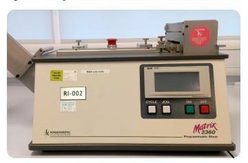
Fig. 5 Kinematic Matrix™ 2360 Programmable Shears
