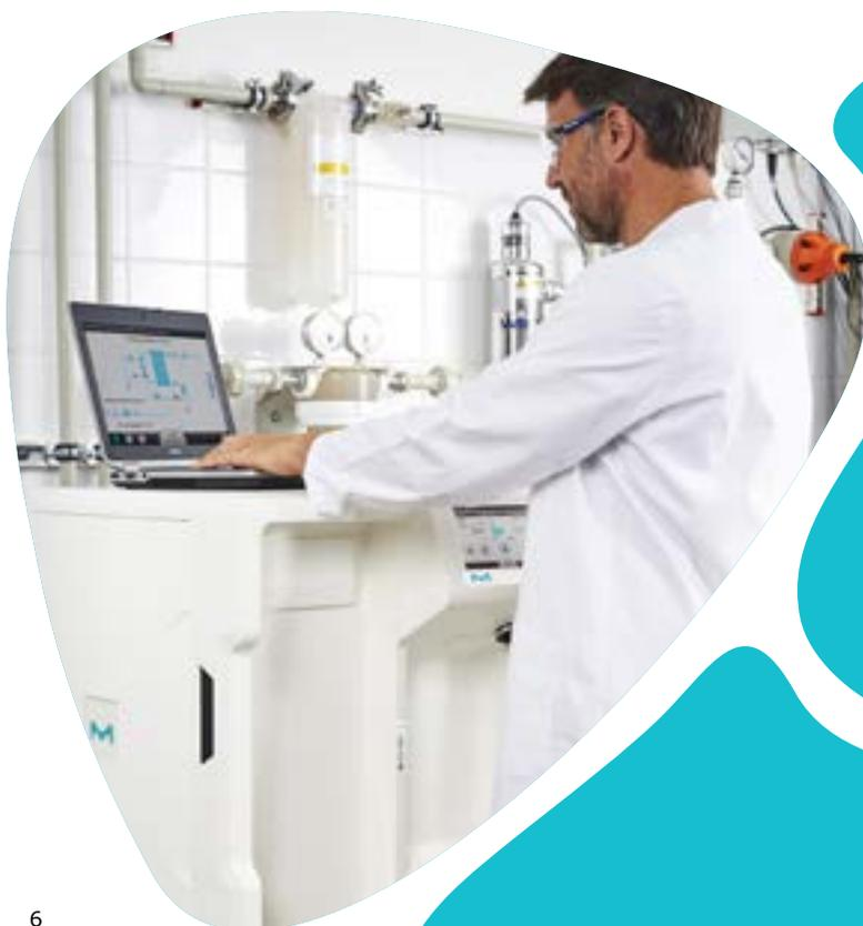
En una configuración óptima, que consta de un filtro Opticap®, una lámpara UV y un lazo bien diseñado y mantenido, el agua producida desde el sistema Milli-Q® HX 7000 SD cumple las normas correspondientes y las farmacopeas enumeradas por encima de todos los puntos de uso.
