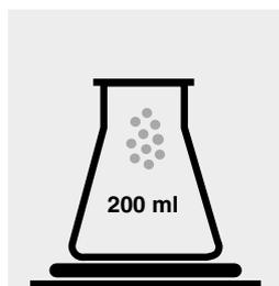
Pesar 10 g de muestra preparada con una exactitud de 1 mg en un matraz Erlenmeyer de 200 ml y realizar la extracción según EN ISO 11052 [1] o el Art. 64 del LFGB 16.01-3 [2]: **muestra de medida.**
