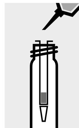
Separar la columna del despósito, hacer recorrer completamente 3 veces 1 ml cada vez de **AOX-3** través de la columna. De har la solución de lavado.
