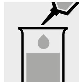
Añadir 0,50 ml de **PO<sub>4</sub>-1** con la pipeta y mezclar.
