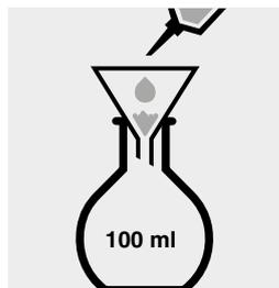
Bañar la muestra con aprox. **80 ml de agua destilada** (recomendamos el art. 1.16754, Agua para análisis EMSURE®) en un matraz de medición de 100 ml.
