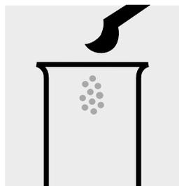
Introducir 1 microcuchara gris rasa de **Cr-1** en un tubo de ensayo seco.
