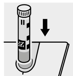
Colocar la **cubeta Σ P** en el compartimiento para cubetas. Hacer coincidir la raya de marcado de la cubeta con la marca de fotómetro. La medición es automática.
