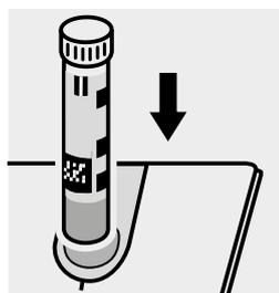
Colocar la cubeta en el compartimiento para cubetas. Hacer coincidir la raya de marcado de la cubeta con la marca de fotómetro. La medición es efectuada automáticamente.
