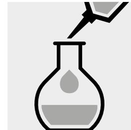
Completar el matraz aforado con agua destilada (recomendamos el art. 1.16754, Agua para análisis EMSURE®) hasta la señal de enrase y mezclar bien.
