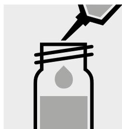
Añadir 1,0 ml de **OA-5** con la pipeta, cerrar la cubeta con la tapa roscada y agitar intensamente.
