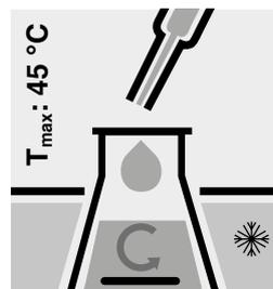
Añadir mediante pipeta de vidrio en cada uno de los dos matraces Erlenmeyer **lentamente, así como agitando y refrigerando**, 25 ml de **ácido sulfúrico para determinación de DQO** (art. 1.17048).
