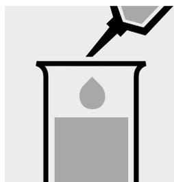
Pipetear 5,0 ml de la muestra en un tubo de ensayo.
