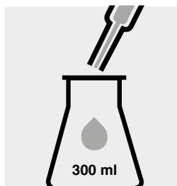
Introducir mediante pipeta de vidrio 20 ml de muestra en un matraz Erlenmeyer de 300 ml con NS 29/32.
