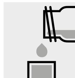
Introducir la muestra de medición en la cubeta y medir **inmediatamente**.
