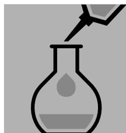
Llenar el matraz aforado con etanol hasta llegar a la marca. **¡Durante esta operación, el matraz debe estar protegido contra la luz!**
