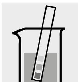
Comprobar el valor del pH de la muestra, intervalo necesario: pH 0–13.
