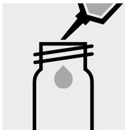
Pipetear 5,0 ml de la muestra en un tubo de ensayo vacío (p. es. tubos de fondo plano, art. 1.14902).
