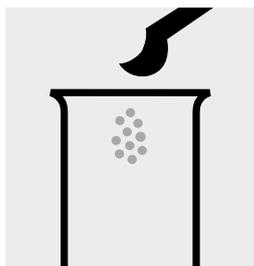
Introducir 1 microcuchara azul rasa de Cl<sub>2</sub>-1 en un tubo de ensayo.
