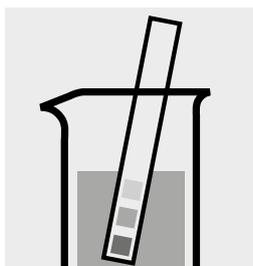
Comprobar el valor del pH de la muestra, intervalo necesario: pH 4–10. En caso necesario, corregir el valor del pH añadiendo gota a gota solución diluida de hidróxido sódico o de ácido clorhídrico.
