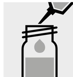
Añadir 5,0 ml de **Zn-6** (art. 1.06146, isobutilmetilcetona) con la pipeta y cerrar el tubo con la tapa roscada.
