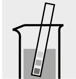
Comprobar el valor del pH de la muestra, intervalo necesario: pH 3–12. En caso necesario, corregir el valor del pH añadiendo gota a gota solución diluida de hidróxido sódico o de ácido sulfúrico.
