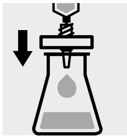
Filtrar la solución de la muestra a través de filtro de membrana de diámetro de poro 0,45  $\mu$ m.
