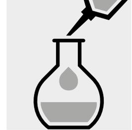
Añadir 20 ml de **reactivo de molibdato de sodio/ácido ascórbico** y mezclar.
