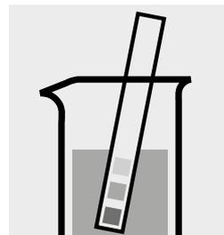
Comprobar el valor del pH de la muestra, intervalo necesario: pH 3–9. En caso necesario, corregir el valor del pH añadiendo gota a gota solución diluida de hidróxido sódico o de ácido clorhídrico.
