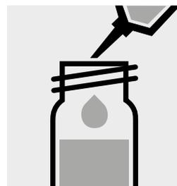
Añadir 5,0 ml de la muestra con la pipeta, cerrar la cubeta con la tapa roscada y mezclar.
