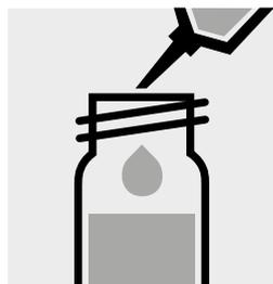
Añadir 3,0 ml de la muestra con la pipeta **cuidadosamente** en una cubeta de reacción, cerrar firmemente con tapa rosca y mezclar intensamente. **¡Atención, la cubeta se calienta!**
