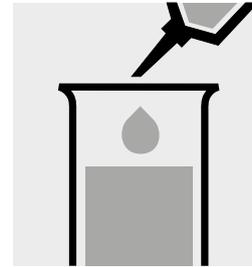
Añadir 0,60 ml de **NH<sub>4</sub>-1** (de test Amonio Spectroquant®, art. 1.14752) con la pipeta y mezclar.
