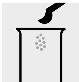
Introducir 1 microcuchara gris rasa de  $\text{SO}_3\text{-1}$  en un tubo de ensayo seco.
