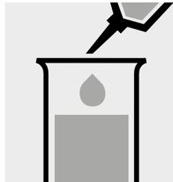
Piptear 5,0 ml de agua destilada (recomendamos el art. 1.16754, Agua para análisis EMSURE®) en un tubo de ensayo.
