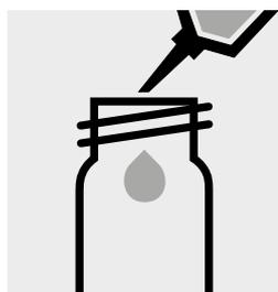
Pipetear 5,0 ml de la **muestra preparada** en una cubeta de reacción, cerrar con la tapa rosca y disolver la sustancia sólida.
