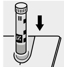
**Sin agitando de nuevo** colocar la cubeta en el compartimento para cubetas. Hacer coincidir la raya de marcado de la cubeta con la marca de fotómetro.
