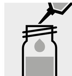
Añadir 3,0 ml de la muestra con la pipeta, cerrar con la tapa rosca y mezclar. **¡Atención, la cubeta se calienta!**
