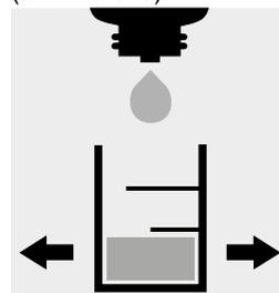
Comprobar el contenido de cloruro en la muestra desenriquecida mediante test Cloruros MQuant® (art. 1.11132) según prescripción de aplicación (ver sitio web): Valor nominal <250 mg/l Cl.
