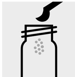
Introducir 1 microcuchara azul rasada de  $\text{Cl}_2\text{-1}$  en una cubeta redonda.
