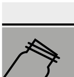
Llenar completamente sin burbujas de aire una cubeta de reacción con la muestra de agua.
