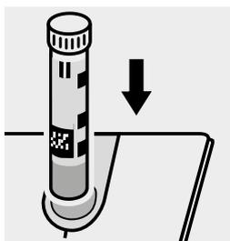
Colocar la cubeta en el compartimento para cubetas. Hacer coincidir la raya de marcado de la cubeta con la marca de fotómetro.
