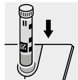
Colocar la **cubeta A** en el compartimiento para cubetas. Hacer coincidir la raya de marcado de la cubeta con la marca de fotómetro. La medición es efectuada automáticamente.
