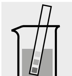
Comprobar el valor del pH de la muestra, intervalo necesario: pH 1,5–2,2. En caso necesario, corregir el valor del pH añadiendo gota a gota solución diluida de hidróxido sódico o de ácido clorhídrico.
