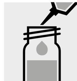
Añadir 2,0 ml de la **mezcla muestra - reactivo** con la pipeta, cerrar la cubeta con la tapa rosca y mezclar.
