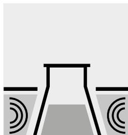
Desgasificar la muestra en un baño ultrasónico.
