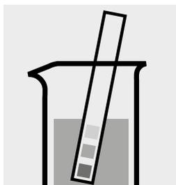
Comprobar el valor del pH de la muestra, intervalo necesario: pH 3 – 11. En caso necesario, corregir el valor del pH añadiendo gota a gota solución diluida de amoníaco o de ácido nítrico.
