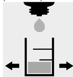
Comprobar el contenido de cloruro en la muestra desenriquecida mediante test Cloruros MQuant® (art. 1.11132) según prescripción de aplicación (ver sitio web): Valor nominal <2000 mg/l Cl<sup>-</sup>.
