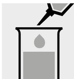
Añadir 0,20 ml de **ácido perclórico 70 - 72 % p. a.** (art. 1.00519) con la pipeta y mezclar.
