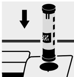
Seleccionar el método con el AutoSelector 2,0 – 75,0 mg/l de  $\text{NH}_4\text{-N}$ .
