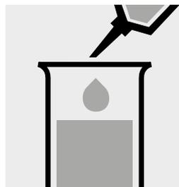
Añadir 10 ml de la muestra con la pipeta en un tubo y mezclar.
