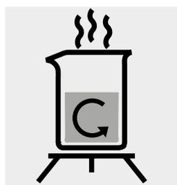
Evaporar casi hasta sequedad 250 ml de la solución de la muestra en un vaso de precipitados sobre la placa calefactora.
