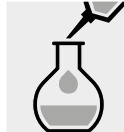
Completar el matraz aforado con agua destilada (recomendamos el art. 1.16754, Agua para análisis EMSURE®) hasta la señal de enrase y mezclar bien: **solución de muestra preparada**.
