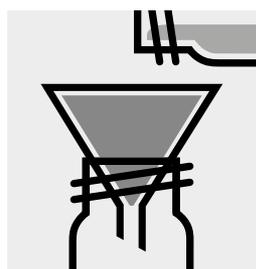
Filtrar a través de un filtro redondo en un tubo con tapa roscada.
