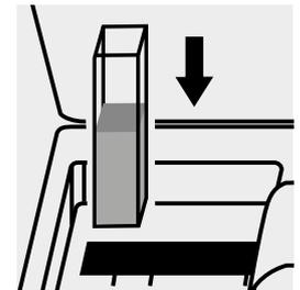
Colocar la cubeta en el compartimiento para cubetas. La medición es efectuada automáticamente.
