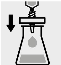
Filtrar o centrifugar las soluciones de la muestra turbias.
