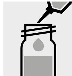
Añadir 1,5 ml de la **muestra preparada** con la pipeta muy lenta, cerrar con la tapa roscaada y mezclar **brevemente**.
