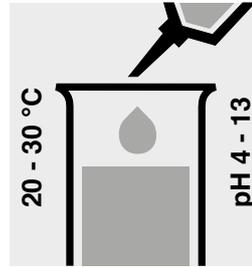
Pipetear 5,0 ml de la muestra en un tubo de ensayo. En caso necesario, corregir el valor del pH añadiendo gota a gota solución diluida de hidróxido sódico o de ácido sulfúrico o temperar la muestra.
