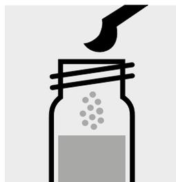
Verter 1 microcuchara rasa de **NO<sub>3</sub>-1K** en una cubeta de reacción, cerrar con la tapa roscada.
