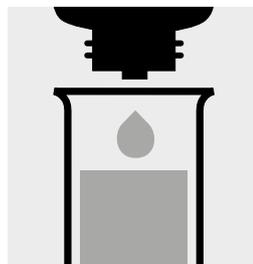
Añadir 1 gota de **Ni-1** y mezclar. Si la solución se decolora, aumentar la dosis de reactivo gota a gota hasta obtener una débil coloración amarilla.
