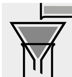
Filtrar toda la mezcla por un filtro hidrófobo según la EN 1141 [1] ó bien el Art. 64 del LFGB 31.00-7 [2]: **muestra de medida**.
