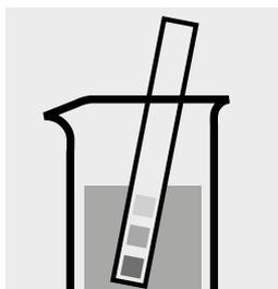
Comprobar el valor del pH de la muestra, intervalo necesario: pH 3–7. En caso necesario, corregir el valor del pH añadiendo gota a gota solución diluida de hidróxido sódico o de ácido acético.
