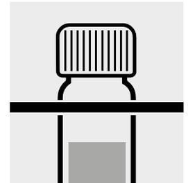
Sacar la cubeta del termorreactor, dejarla enfriar a temperatura ambiente en un soporte para tubos de ensayo: **muestra preparada**.
