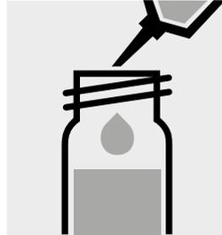
Pipetear 2,0 ml de la muestra en una cubeta de reacción, cerrar con la tapa rosca-da y mezclar.
