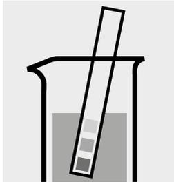
Comprobar el valor del pH de la muestra, valor necesario: pH 7,0. En caso necesario, corregir el valor del pH añadiendo gota a gota solución diluida de hidróxido sódico o de ácido sulfúrico.
