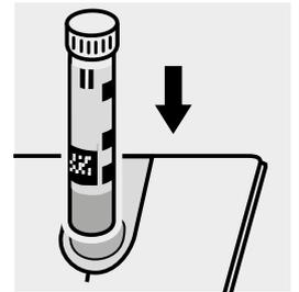
Colocar la **cubeta Σ P** en el compartimiento para cubetas. Hacer coincidir la raya de marcado de la cubeta con la marca de fotómetro. La medición es efectuada automáticamente.
