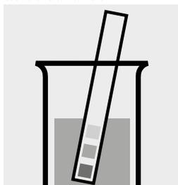
Comprobar el valor del pH de la muestra, intervalo necesario: pH 10–12. En caso necesario, corregir el valor del pH añadiendo gota a gota solución diluida de hidróxido sódico o de ácido sulfúrico.
