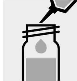
Pipetear 0,50 ml de la muestra en una cubeta de reacción, cerrar con la tapa rosca y mezclar.
