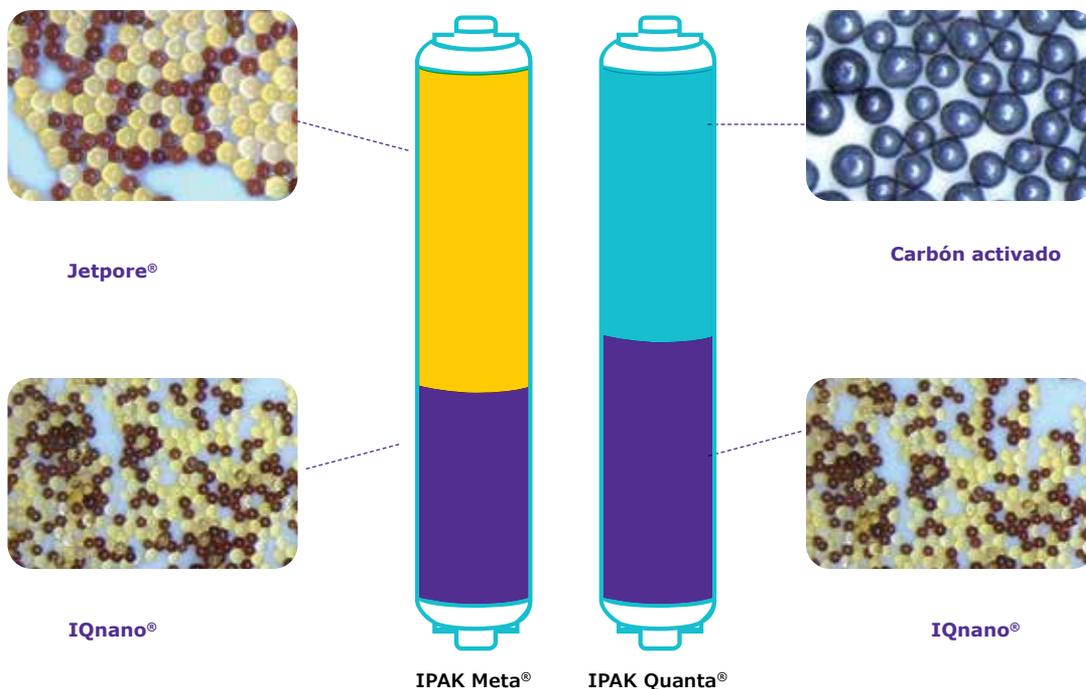
Completado con carbón activado sintético de alta calidad, el cartucho IPAK Quanta® también capta trazas de contaminantes orgánicos una vez han sido oxidados por la nueva lámpara de fotooxidación en línea del sistema Milli-Q® IQ 7000. Esta exclusiva lámpara UV exenta de mercurio  $e_{ch_2O}$  asegura la oxidación de los contaminantes orgánicos utilizando la tecnología de excímeros (dímeros excitados) de xenón, que emiten a una longitud de onda de 172 nm.
