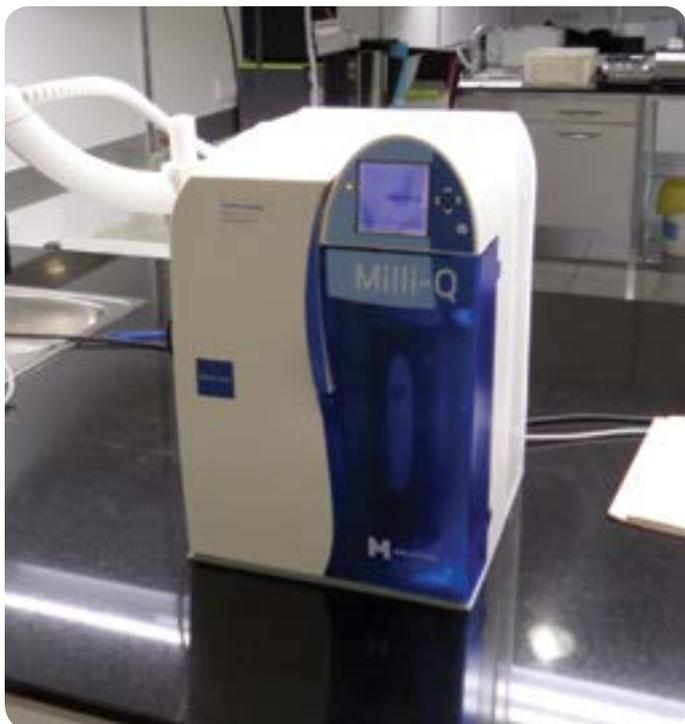
Sistema Milli-Q® Reference con filtro Millipak® en el laboratorio de bioquímica.
