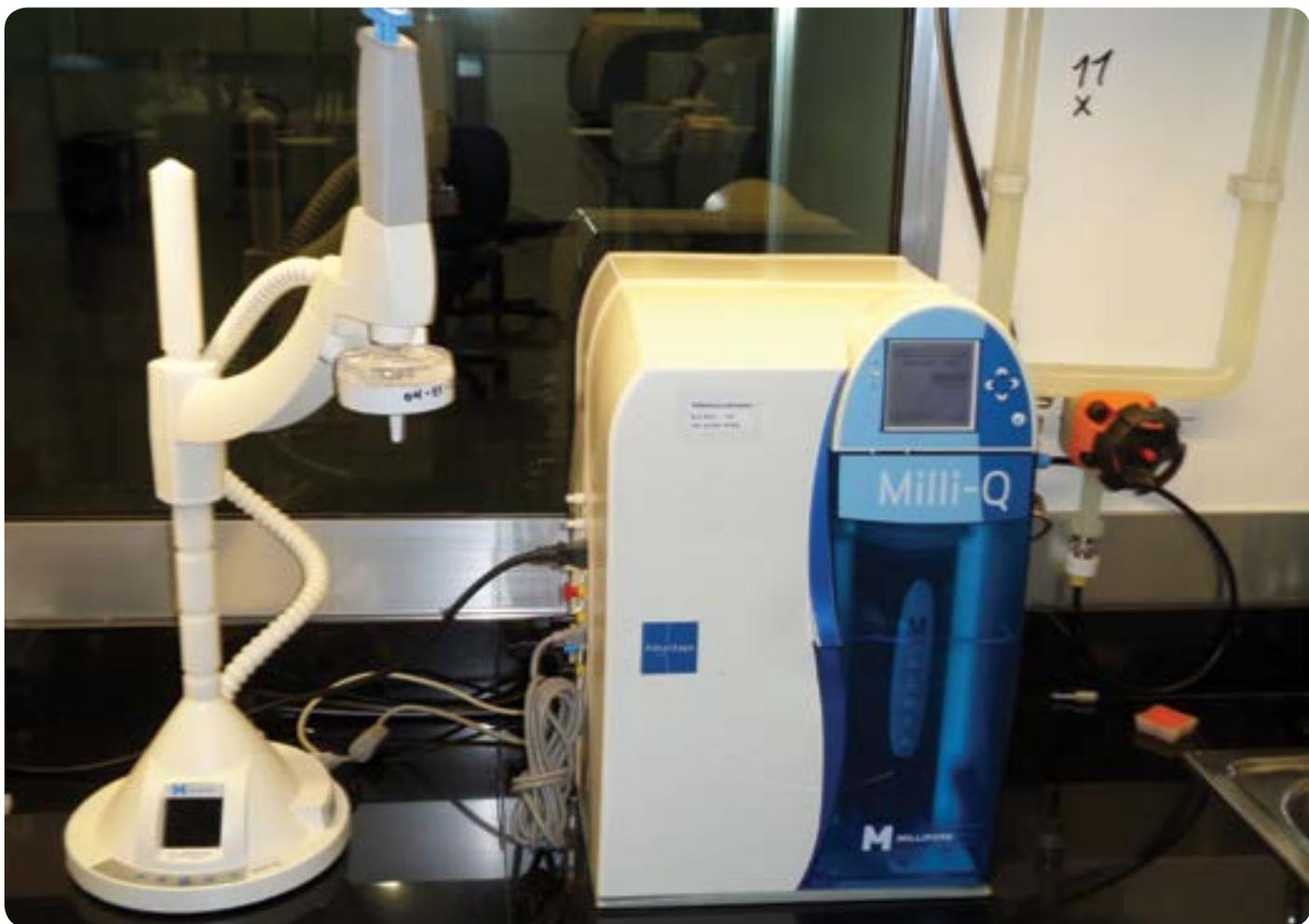
Sistema Milli-Q® Advantage A10 con dispensador Q-POD® y filtro Millipak® en el laboratorio de HPLC. Este sistema también abastece a otro dispensador Q-POD® remoto que tiene un ultrafiltro BioPak®, situado en el laboratorio de biología molecular.
