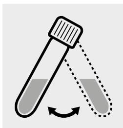
Poner en suspensión el sedimento del fondo de la cubeta mediante agitación por balanceo.
