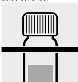
Sacar la cubeta del termoreactor, dejarla enfriar a temperatura ambiente en un soporte para tubos de ensayo: **muestra preparada**.
