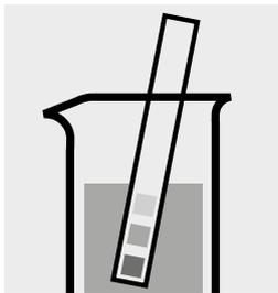
Comprobar el valor del pH de la muestra, intervalo necesario: pH 5–10. En caso necesario, corregir el valor del pH añadiendo gota a gota solución diluida de hidróxido sódico o de ácido clorhídrico.
