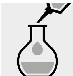
Completar el contenido del matraz aforado hasta la marca con **ciclohexano para espectroscopia Uvasol®** (art. 1.02822) y mezclar.
