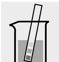
Comprobar el valor del pH de la muestra, intervalo necesario: pH 4–8. En caso necesario, corregir el valor del pH añadiendo gota a gota solución diluida de hidróxido sódico o de ácido sulfúrico.
