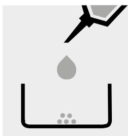
Disolver la ceniza en 2 - 3 ml de **ácido clorhídrico 2 mol/l**.
