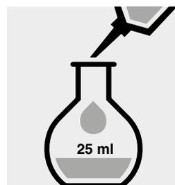
Completar el matraz aforado con agua destilada (recomendamos el art. 1.16754, Agua para análisis EMSURE®) hasta la señal de enrase, mezclar bien y, si es necesario, filtrar: **muestra preparada.**
