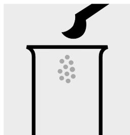
Introducir 1 microcuchara azul rasa de  $\text{Cl}_2\text{-1}$  en un tubo de ensayo.
