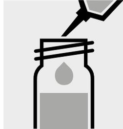
Añadir 5,0 ml de **ácido sulfúrico al 40 %** con la pipeta. Cerrar con la tapa roscada y mezclar.
