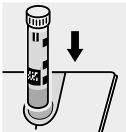
Colocar la cubeta de la muestra en el compartimiento para cubetas. Hacer coincidir la raya de marcado de la cubeta con la marca de fotómetro.
