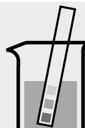
Comprobar el valor del pH de la muestra, intervalo necesario: pH 3–9. En caso necesario, corregir el valor del pH añadiendo gota a gota solución diluida de hidróxido sódico o de ácido clorhídrico.
