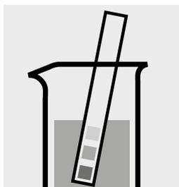
Comprobar el valor del pH de la muestra, intervalo necesario: pH 3–9. En caso necesario, corregir el valor del pH añadiendo gota a gota solución diluida de hidróxido sódico o de ácido sulfúrico.
