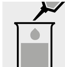
Añadir 0,50 ml de la muestra con la pipeta y mezclar.
