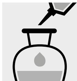
Añadir 10 ml de clorofor-mo con la pipeta, cerrar el embudo de decantación.
