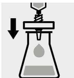
Filtrar la solución de la muestra a través de filtro de membrana de diámetro de poro 0,45 µm.
