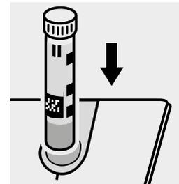
**Sin agitando de nuevo** colocar la cubeta en el compartimiento para cubetas. Hacer coincidir la raya de marcado de la cubeta con la marca de fotómetro.
