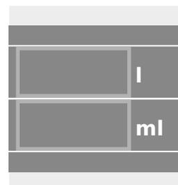
Seleccionar el método núm. **2504**. Introducir el volumen de la muestra original en litros y del extracto en mililitros (aquí: 10 ml).
