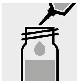
Añadir 1,0 ml de **OA-4K** con la pipeta, cerrar la cubeta con la tapa roscada y agitar intensamente.
