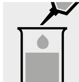
Pipetear 5,0 ml de agua destilada (recomendamos el art. 1.16754, Agua para análisis EMSURE®) en un segundo tubo de ensayo. (Blanco)
