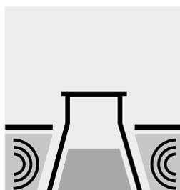
Desgasificar la muestra en un baño ultrasónico.
