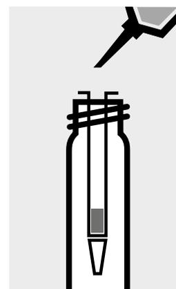
Separar la columna del despósito, hacer recorrer completamente 3 veces 1 ml cada vez de **AOX-3** a través de la columna. De har la solución de lavado.
