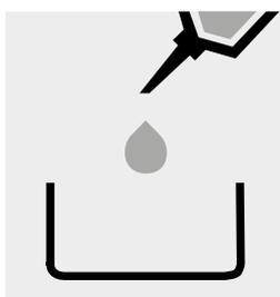
Pipetear 25,0 ml de muestra en una cápsula de platino y realizar una incineración según EN 1136 [3].
