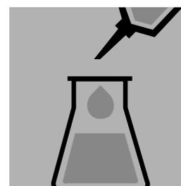
Acidificar parte del extracto con **ácido clorhídrico 1 mol/l Titripur®** (art. 1.09057) (50 µl por 5 ml de extracto).
