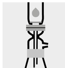
Filtrar la **solución preparada** bajo vacío a través de un filtro de membrana a un matraz Erlenmeyer seco y limpio.
