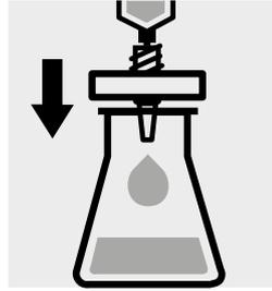
Filtrar o centrifugar las soluciones turbias de la muestra.
