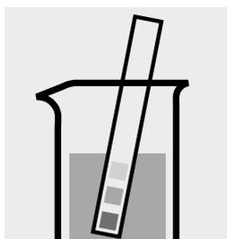
Comprobar el valor del pH de la muestra, intervalo necesario: pH 3–8. En caso necesario, corregir el valor del pH añadiendo gota a gota solución diluida de hidróxido sódico o de ácido clorhídrico.
