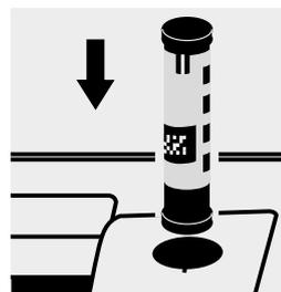
Seleccionar el método con el AutoSelector 5 – 150 mg/l de  $\text{NH}_4\text{-N}$ .
