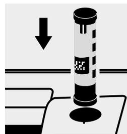
Seleccionar el método con el AutoSelector 0,5 – 50,0 mg/l de Si.
