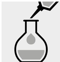
Completar el contenido del matraz aforado hasta la marca con **isooctano para espectroscopia Uvasol®** (art. 1.04718) o **ciclohexano para espectroscopia Uvasol®** (art. 1.02822) y mezclar.
