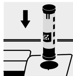
Seleccionar el método con el AutoSelector 5 – 500 mg/l de Si.
