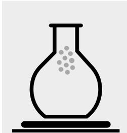
Pesar en un matraz aforado la muestra pulverizada con una exactitud de 0,1 mg.
