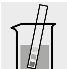
Comprobar el valor del pH de la muestra, intervalo necesario: pH 2–12. En caso necesario, corregir el valor del pH añadiendo gota a gota solución diluida de ácido sulfúrico.
