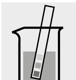
Comprobar el valor del pH de la muestra, intervalo necesario: pH 3–8. En caso necesario, corregir el valor del pH añadiendo gota a gota solución diluida de hidróxido sódico o de ácido sulfúrico.
