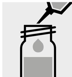
Pipetear 0,100 ml de agua destilada (recomendamos el art. 1.16754, Agua para análisis EMSURE®) en un tubo de ensayo con tapa roscada.
