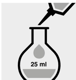
Pipetear 10 ml de la muestra en un matraz aforado de 25 ml.
