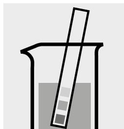
Comprobar el valor del pH de la muestra, intervalo necesario: pH 6–8. En caso necesario, corregir el valor del pH añadiendo gota a gota solución diluida de hidróxido sódico o de ácido nítrico.
