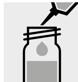
Añadir 3,0 ml de la muestra con la pipeta, cerrar con la tapa roscaada y mezclar. **¡Atención, la cubeta se calienta!**
