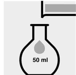
Transferir con **ácido sulfúrico 0,05 mol/l** a un matraz aforado de 50 ml.
