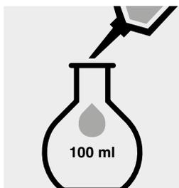
Pipetear un volumen conveniente de la solución de muestra preparada con una exactitud de 0,1 ml en un matraz aforado de 100 ml.
