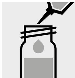
Pipetear 5,0 ml de la muestra en una cubeta de reacción, cerrar con la tapa rascada y mezclar.
