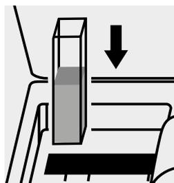
Colocar la **cubeta B** en el compartimento para cubetas. La medición es efectuada automáticamente.
