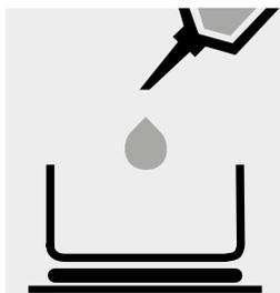
Pesar la muestra con una exactitud de 1 mg en un recipiente conveniente y realizar una digestión húmeda o bien una incineración según el Art. 64 del LFGB 01.00-92 [1].
