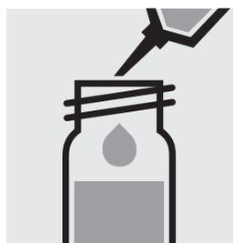
Pipetear 5,0 ml de la muestra en un tubo de ensayo con tapa rosca. (**Importante: no usar tubos de ensayo hechos de vidrio que contenga boro.**)
