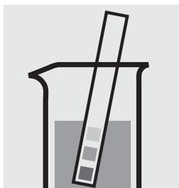
Comprobar el valor del pH de la muestra, intervalo necesario: pH 2,5 – 7,5. En caso necesario, corregir el valor del pH añadiendo gota a gota solución diluida de hidróxido sódico o de ácido nítrico.
