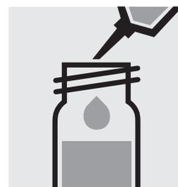
Añadir 2,0 ml de la **mezcla muestra - reactivo** con la pipeta, cerrar la cubeta con la tapa roscada y mezclar.
