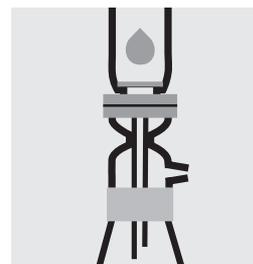
Filtrar la **solución ajustada** bajo vacío a través de un filtro de membrana a un matraz Erlenmeyer seco y limpio.
