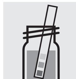
Comprobar el valor del pH, intervalo necesario: pH 1,5–3,5. En caso necesario, corregir el valor del pH añadiendo gota a gota solución diluida de ácido sulfúrico.
