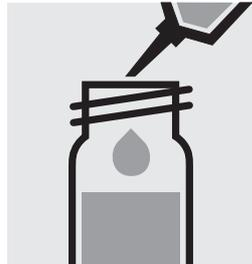
Pipetear 2,0 ml de la muestra en un tubo con tapa rosca.
