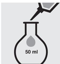
Introducir 1 ml de muestra preparada en un matraz aforado de 50 ml.
