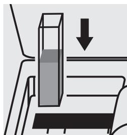
Colocar la **cubeta B** en el compartimiento para cubetas. La medición es efectuada automáticamente.
