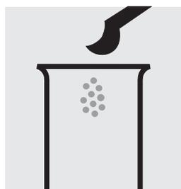
Introducir 1 microcuchara gris rasada de  $\text{SO}_3\text{-1}$  en un tubo de ensayo seco.
