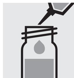
Pipetear 0,50 ml de **Zn-2K** en una cubeta de reacción, cerrar la cubeta con la tapa roscada y mezclar.
