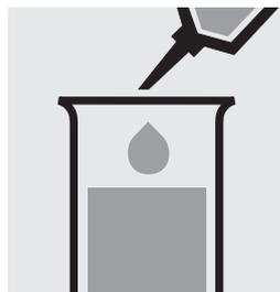
Pipetear 10 ml de la muestra en un tubo de ensayo.
