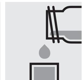
Introducir la muestra de medición en la cubeta y medir **inmediatamente**.
