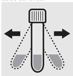
Agitar intensamente ambas cubetas para disolver la sustancia sólida.
