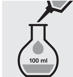
Pipetear 4,0 ml de la muestra diluida en un matraz aforado de 100 ml, llenar con agua destilada hasta la señal de enrase y mezclar bien.
