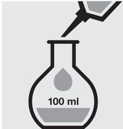
Pipetear 5,0 ml de la muestra en un matraz aforado de 100 ml, llenar con agua destilada hasta la señal de enrase y mezclar bien.
