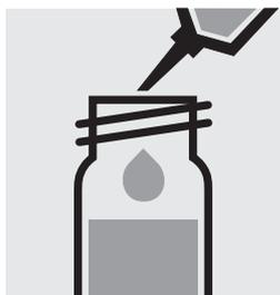
Añadir 3,0 ml de la muestra con la pipeta **cuidadosamente** en una cubeta de reacción, cerrar firmemente con tapa roscada y mezclar intensamente. **¡Atención, la cubeta se calienta!**
