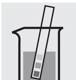
Comprobar el valor del pH de la muestra, intervalo necesario: pH 4–10. En caso necesario, corregir el valor del pH añadiendo gota a gota solución diluida de hidróxido sódico o de ácido sulfúrico.
