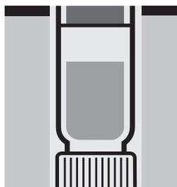
Calentar la cubeta de reacción **en posición invertida** en el termorreactor 2 horas a 120 °C.
