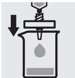
Filtrar **10 - 20 ml de la solución preparada** a través de filtro de membrana en un vaso de precipitados seco y limpio.
