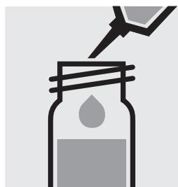
Añadir 8,0 ml de **solución de hidróxido de sodio 2,5 mol/l** con la pipeta y mezclar.
