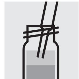
Mediante una pipeta Pasteur, aspirar la capa clara superior.
