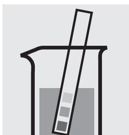
Comprobar el valor del pH de la muestra, intervalo necesario: pH 2–10. En caso necesario, corregir el valor del pH añadiendo gota a gota solución diluida de hidróxido sódico o de ácido sulfúrico.
