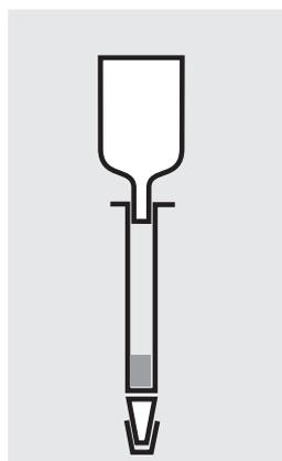
Conectar entre sí el despósito de vidrio y la columna preparada (cerrada por la parte de abajo).
