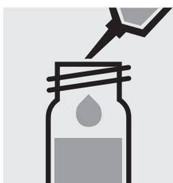
Pipetear 0,100 ml de solución de muestra preparada (filtrado) en un tubo de ensayo con tapa roscada.
