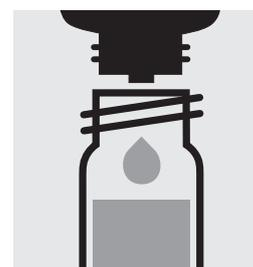
Añadir 5 gotas de **AOX-4**, cerrar con la tapa roscada y mezclar. Dejar sedimentar el carbón. solución sobrenadante: **muestra preparada**
