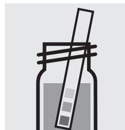
Comprobar el valor del pH de la muestra, intervalo necesario: pH 12–13. Si es necesario, corregir el valor del pH añadiendo gota a gota solución diluida de hidróxido sódico.
