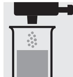
Añadir 1 dosis de Fe-3 con el dosificador azul. Agitar intensamente para disolver la sustancia sólida.
