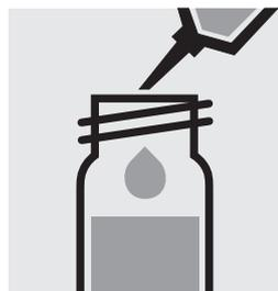
Añadir 0,50 ml de **Sn-1K** con la pipeta, cerrar con la tapa roscada y mezclar.
