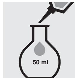
Introducir 20 ml de **ácido sulfúrico 0,05 mol/l** en un matraz aforado de 50 ml.
