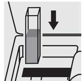
Colocar la cubeta en el compartimiento para cubetas. La medición es efectuada automáticamente.
