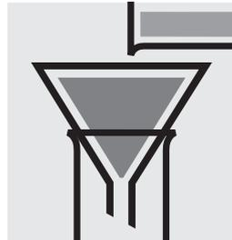
En caso de impurezas, filtrar la muestra sirviéndose de un papel de filtraje rápido.
