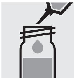
Pipetear 1,0 ml de la muestra en una cubeta de reacción y mezclar.
