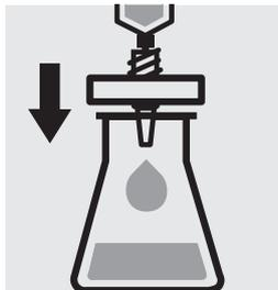
Filtrar la solución de la muestra a través de filtro de membrana de diámetro de poro 0,45  $\mu\text{m}$ .
