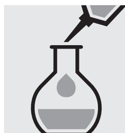
Añadir 20 ml de **ácido sulfúrico 1 mol/l**.
