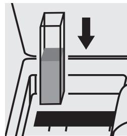
Colocar la cubeta en el compartimento para cubetas. La medición es efectuada automáticamente.
