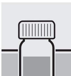
Regular la temperatura del tubo en el baño de agua a  $95 \pm 5$  °C durante **exactamente** 10 minutos.
