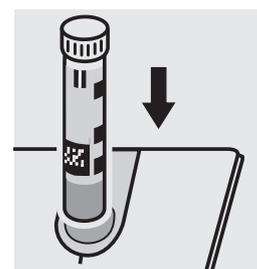
Colocar la **cubeta Σ P** en el compartimiento para cubetas. Hacer coincidir la raya de marcado de la cubeta con la marca de fotómetro. La medición es efectuada automáticamente.
