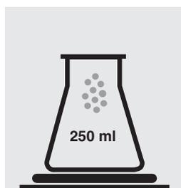
Pesar  $50,0 \pm 0,1$  g de la muestra homogeneizada en un matraz Erlenmeyer de 250 ml.
