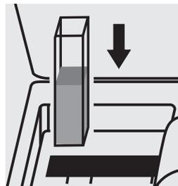
Introducir la cubeta en el compartimento para cubetas. La medición es efectuada automáticamente.
