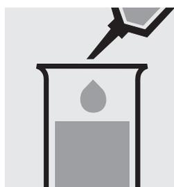
Mezlar 2 ml de solución de muestra preparada con 8 ml de **solución de reactivo: muestra de medida.**
