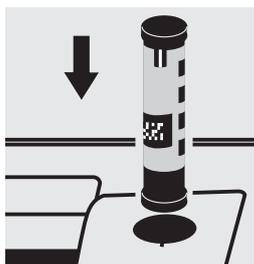
Seleccionar el método con el AutoSelector 2,5 – 25,0 mg/l de Cl.
