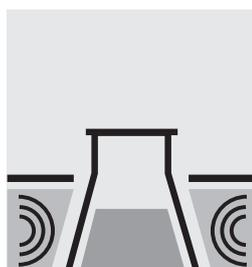
Desgasificar la muestra en un baño ultrasónico.
