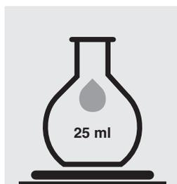
**Pesar entre 100 mg y 500 mg de la muestra** en un matraz aforado de 25 ml.
