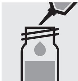
Añadir 0,10 ml de la muestra con la pipeta **cuidadosamente** en una cubeta de reacción, cerrar firmemente con tapa rosca y mezclar intensamente. **¡Atención, la cubeta se calienta!**
