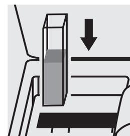
Colocar la **cubeta A** en el compartimiento para cubetas. La medición es efectuada automáticamente.
