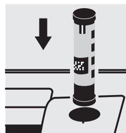
Seleccionar el método con el AutoSelector 0,025 – 5,00 mg/l.
