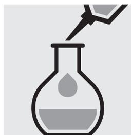
Completar el contenido del matraz aforado hasta la marca con **isooctano para espectroscopia Uvasol®** (art. 1.04718) y mezclar.
