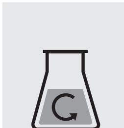
Agitar la solución no filtrada de la muestra para que las sustancias turbias se repartan uniformemente. No dispersar los ingredientes, **medir inmediatamente**.
