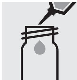
Pipetear 1,0 ml de **B-1K** en una cubeta de reacción, cerrar con la tapa roscaada y mezclar.
