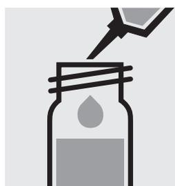
Pipetear 5,0 ml de la muestra en una cubeta de reacción, **¡no mezclar!**
