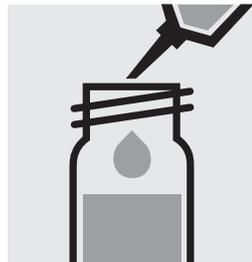
Añadir 3,0 ml de la **muestra en blanco desenriquecida** con la pipeta **cuidadosamente** en una segunda cubeta de reacción, cerrar firmemente con tapa roscada y mezclar intensamente. **¡Atención, la cubeta se calienta!**
