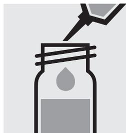
Añadir 0,10 ml de la muestra con la pipeta, cerrar con la tapa roscaada y mezclar. **¡Atención, la cubeta se calienta!**
