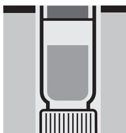
Calentar la cubeta de reacción **en posición invertida** en el termostato 2 horas a 120 °C.
