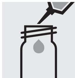
Pipetear 5,0 ml de la muestra en una cubeta de reacción, cerrar con la tapa roscaada y disolver la sustancia sólida.
