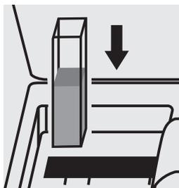
Introducir la cubeta en el compartimento para cubetas. La medición del valor en blanco es efectuada automáticamente.
