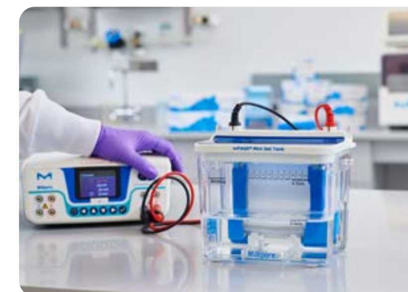
1-D SDS-PAGE separation with mPAGE® Mini Gel Tank
